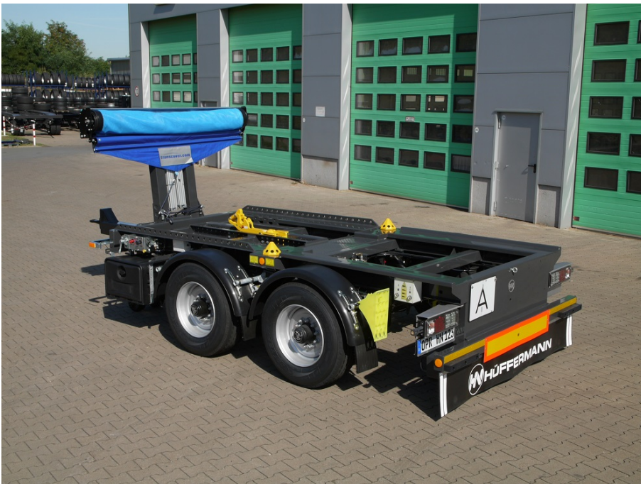
Zentrier-Fix umsteckbar auf verschiedene Behältergrößen
