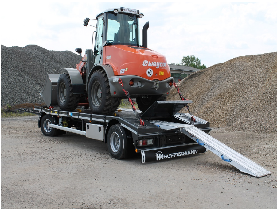
Versenkte und variabel umschraubbare Zurrpunkte im Außenrahmen
