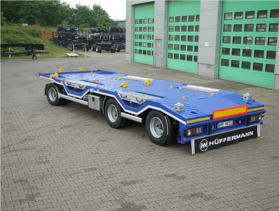
Sonderausstattung Radmulden, ISO-Container- und Absetzbehälter Ausstattung
