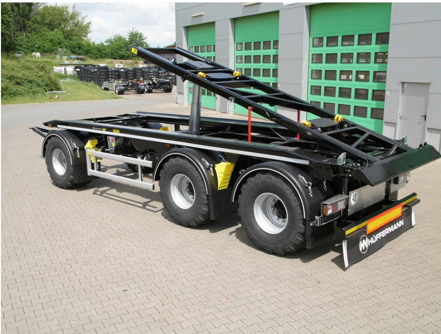
OPTIONAL: 22,5 Zoll Bereifung und Aluminiumfelgen
