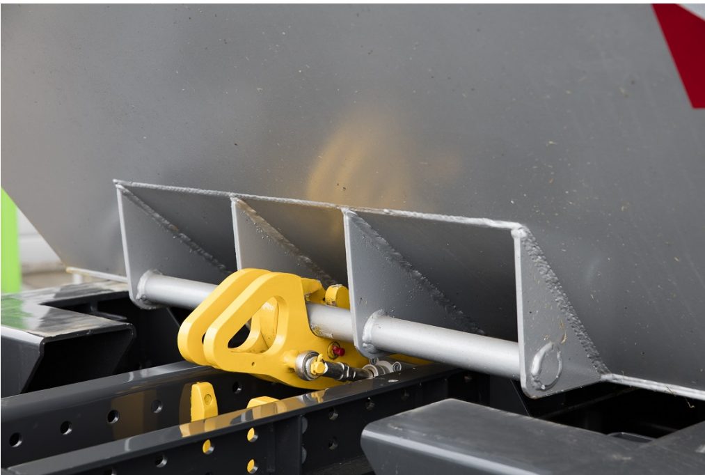
Ladungssicherung optimale Behälterpositionierung durch 8-fach verstellbaren Zentrier-Fix
