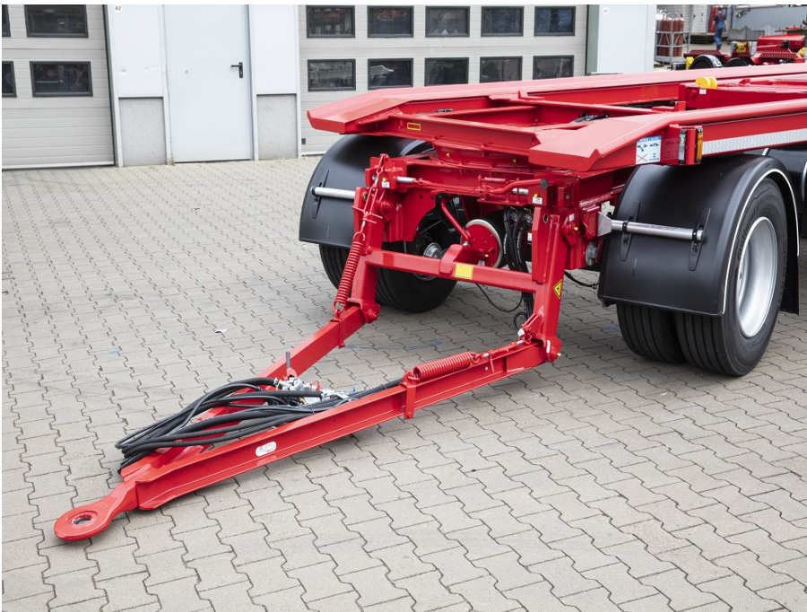
Sonderausführung Laufbahnverbreiterung Innen- und Außenzentrierung
