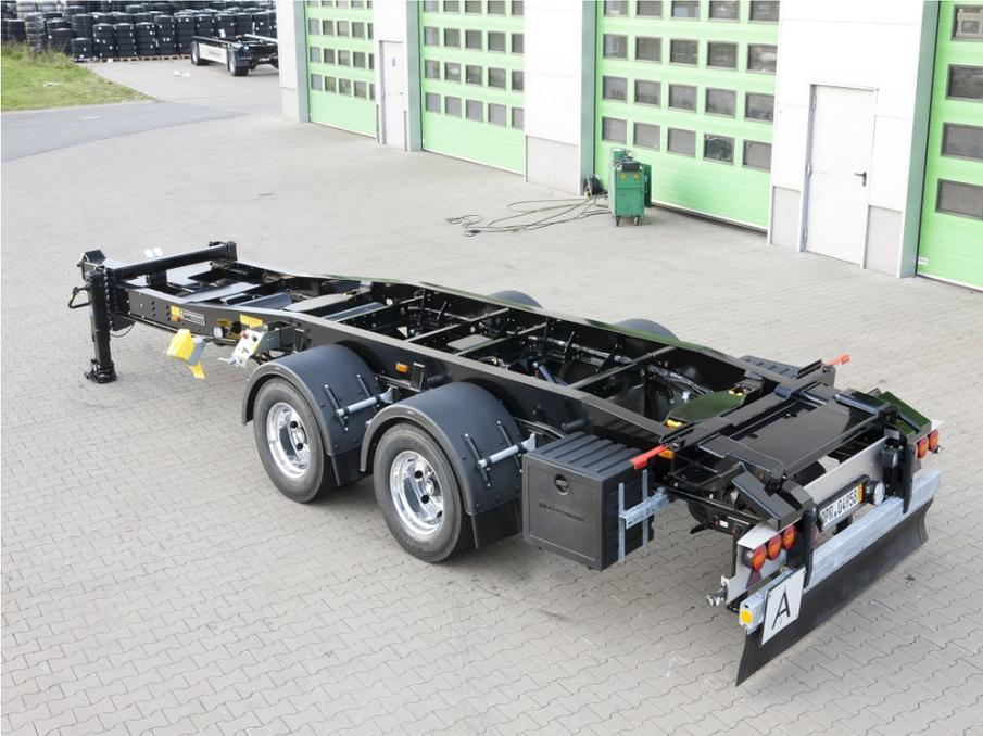
Sonderausrüstung 3 LED Rundleuchten und lackierter Schlitten
