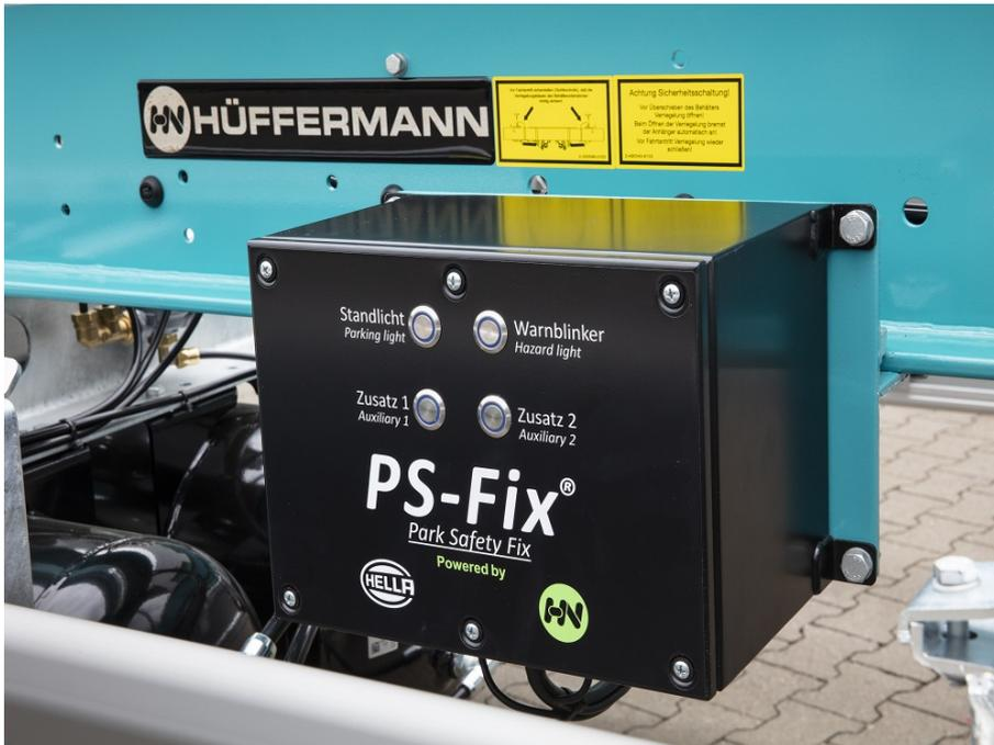
OPTIONAL: Das autarke Beleuchtungssystem für mehr Sicherheit. Das PS-Fix verfügt über vier Funktionen: Parklicht, Warnblinkfunktion, Zusatzbeleuchtung und Blitzleuchten.
