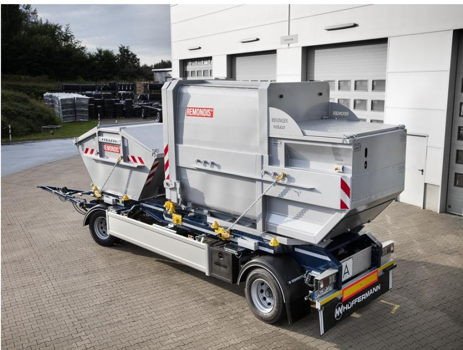
Vario Carrier für zwei Absetzbehälter mit Mulde und Müllpresse
