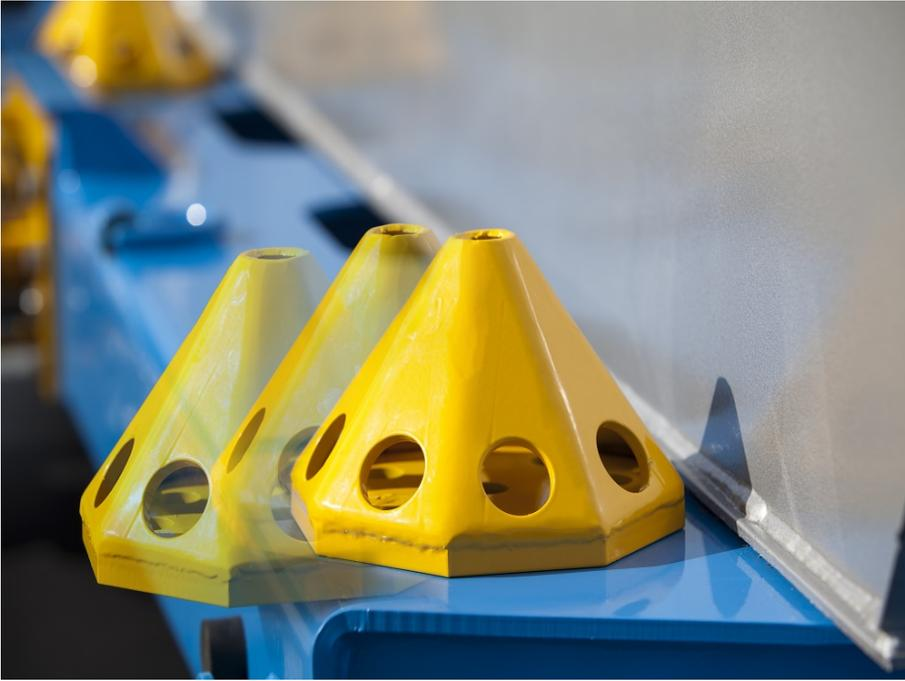
Ladungssicherung optimale Behälterpositionierung durch 8-fach verstellbaren Zentrier-Fix
