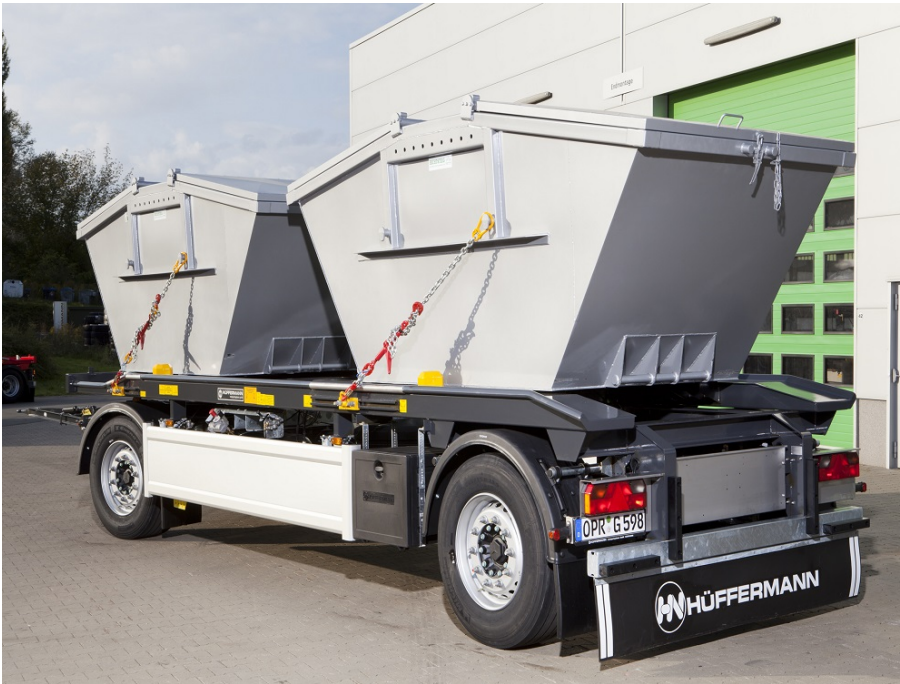
Kombinierte Ladungssicherung mit Zentrier-Fix und Zurrketten
