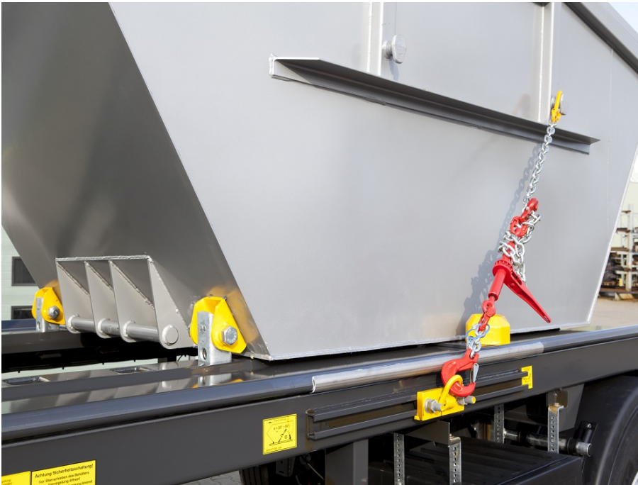
Kombinierte Ladungssicherung mit Zentrier-Fix und Zurrketten
