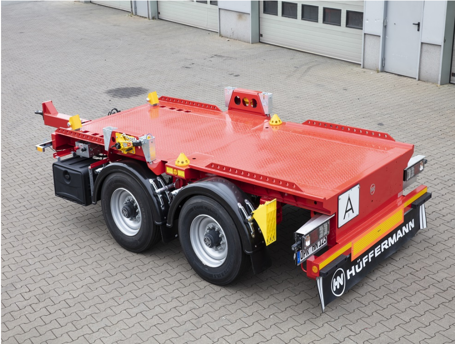
Sonderausstattung geschlossener Ladeboden aus Stahlblech und Safety-Fix
