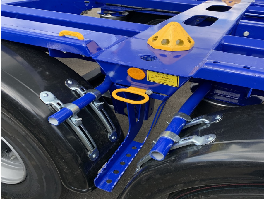
Zentrier-Fix umsteckbar auf verschiedene Behältergrößen
