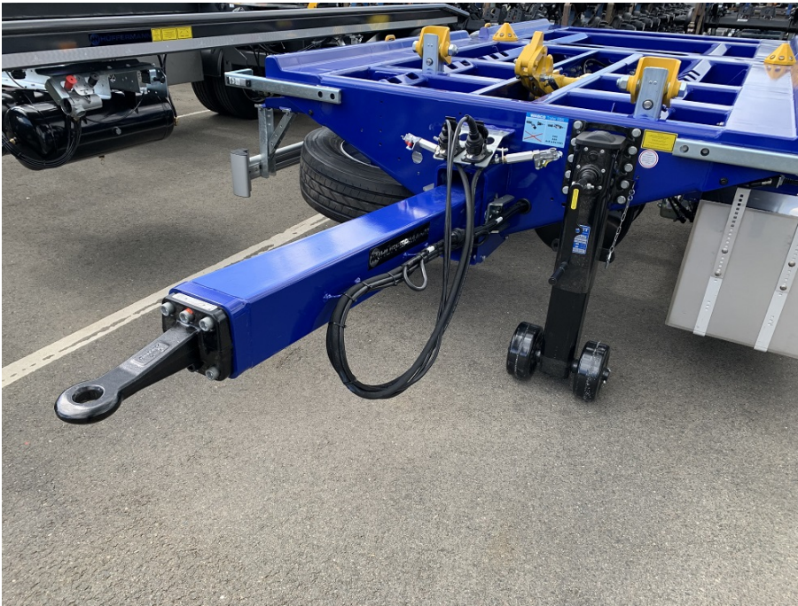
Frontansicht mit Stützwinde, höheneinstellbarem Zugrohr und schraubbarer Zugöse
