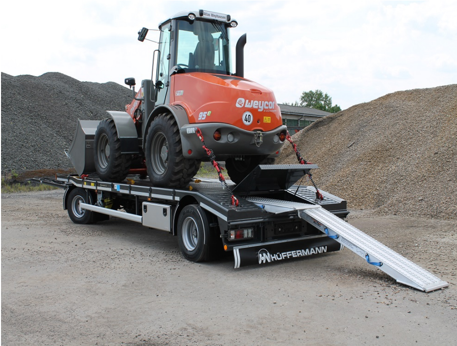
Verzurrung von Baumaschinen
