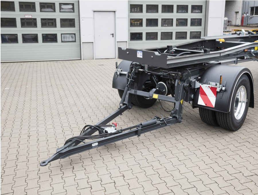
Abgesenkte Zuggabel bei Frontbeladung
