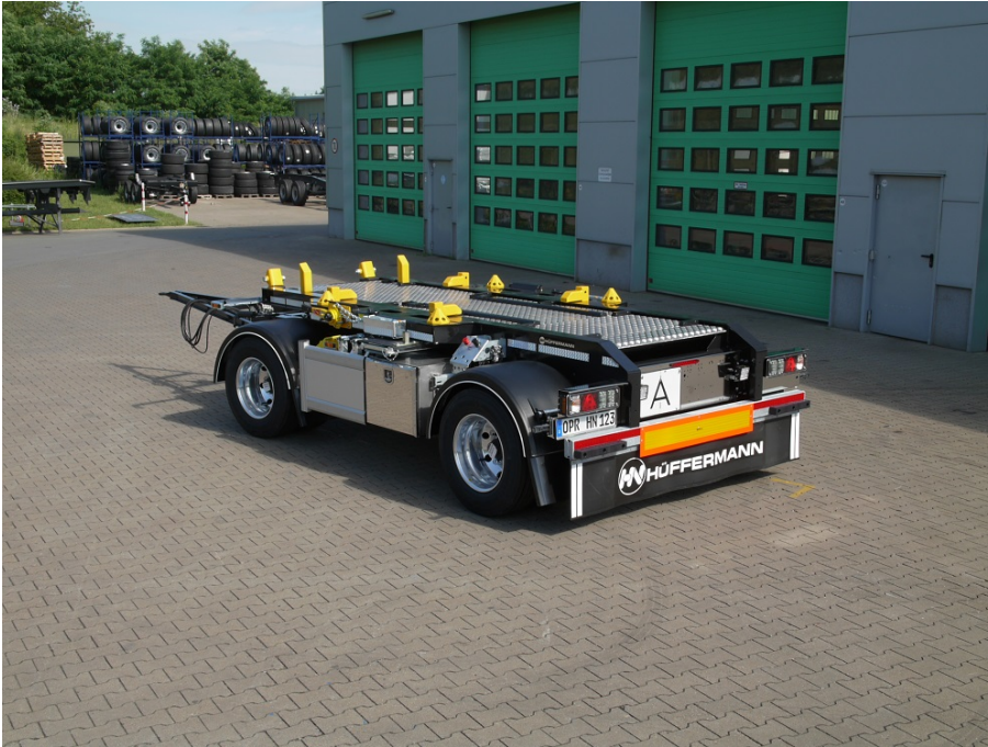
Sonderausstattung für einen Absetzbehälter mit elegance edition, SafetyFix und Boden für Müllpressen
