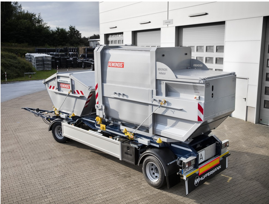
Sonderausstattung für einen Absetzbehälter mit elegance edition, SafetyFix und Boden für Müllpressen
