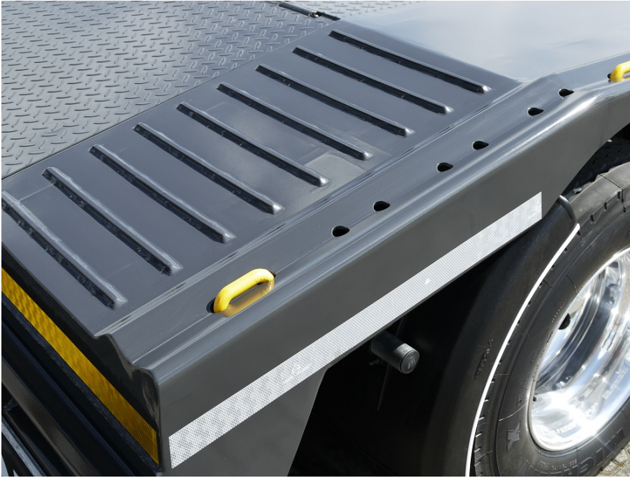
Versenkte und variabel umschaubare Zurrpunkte im Außenrahmen
