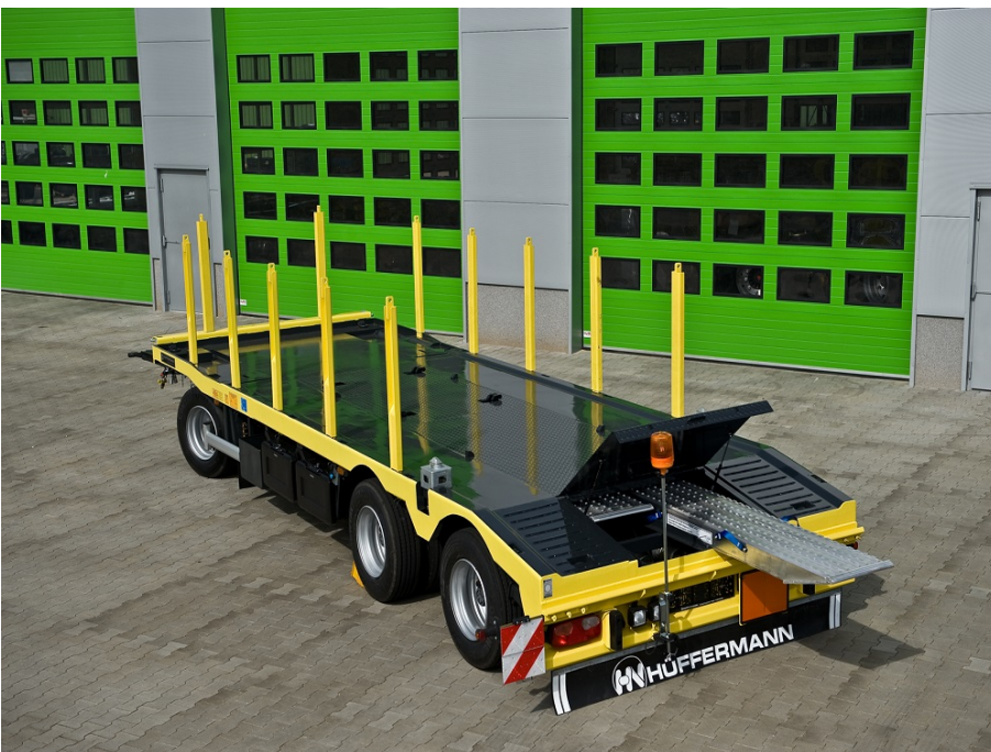
Sonderausstattung ISO-Container Aufnahme, Rungen, Aluräder und 3 LED Rundleuchten
