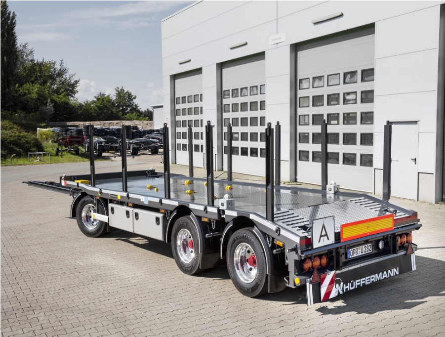
Sonderausstattung ISO-Container Aufnahme, Rungen, Aluräder und 3 LED Rundleuchten
