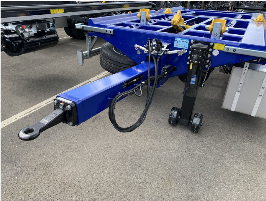
Frontansicht mit Stützwinde, höheneinstellbarem Zugrohr und schraubbarer Zugöse
