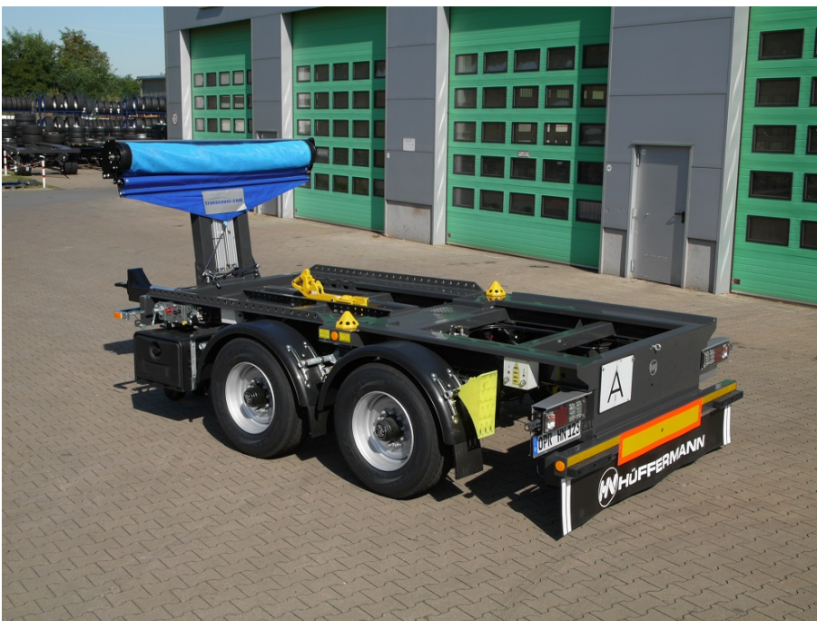
Zentrier-Fix umsteckbar auf verschiedene Behältergrößen
