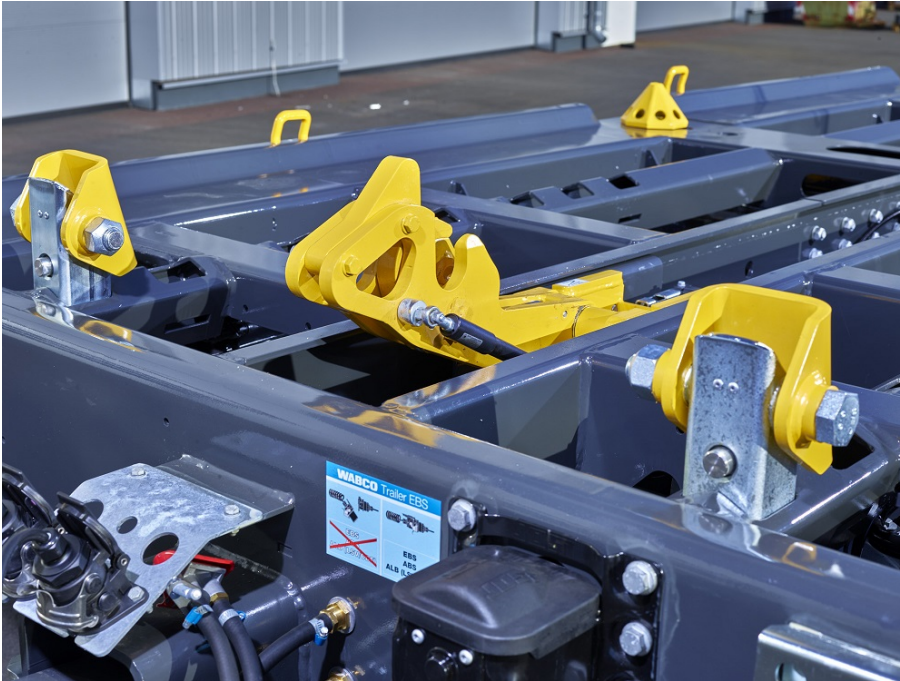
OPTIONAL: Kettenlose Ladungssicherung - verstellbarer Multi-Fix
