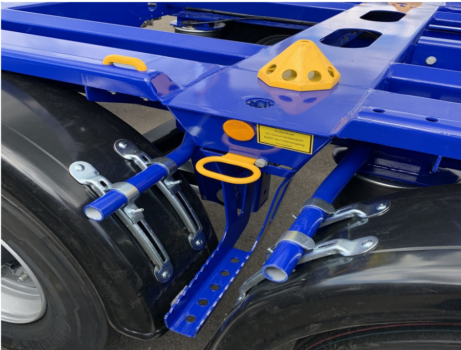
Zentrier-Fix umsteckbar auf verschiedene Behältergrößen
