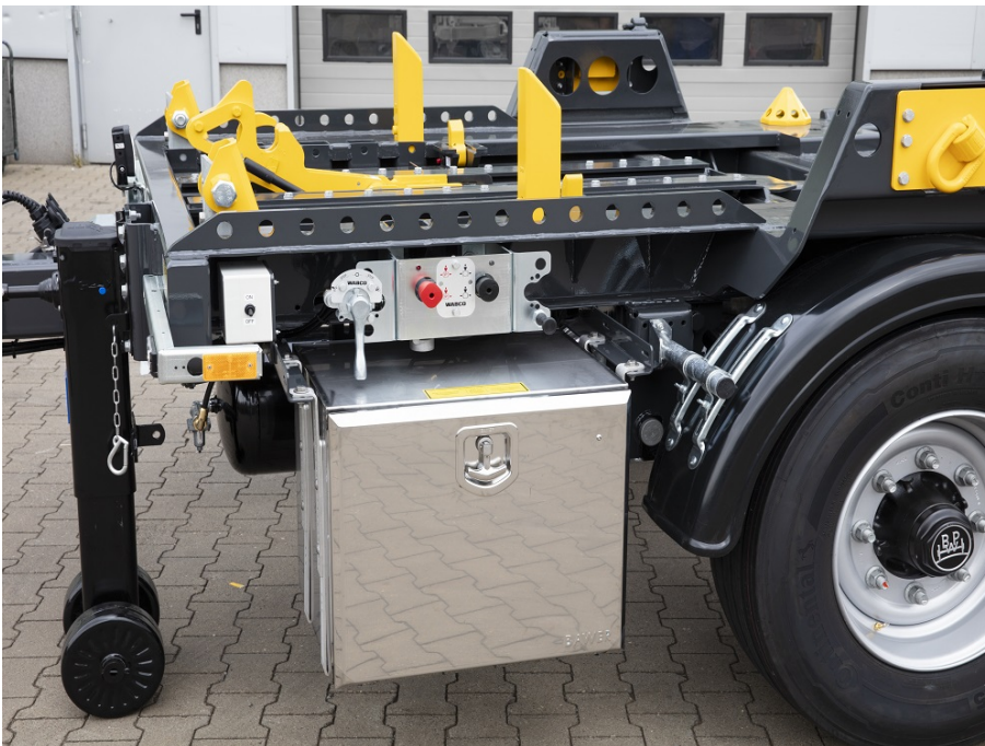
OPTIONAL: Kettenlose Ladungssicherung - verstellbarer Multi-Fix
