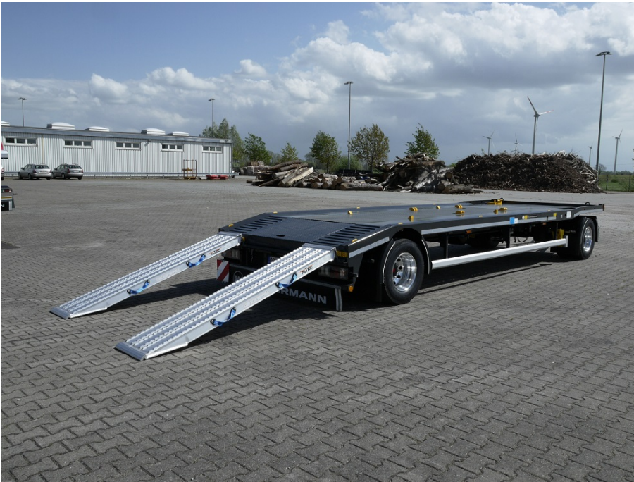
2-Achs Multi-Carrier mit Auffahrampen
