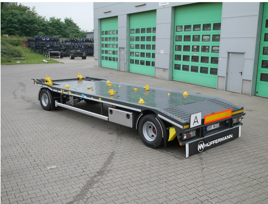
2-Achs Multi-Carrier mit Auffahrampen
