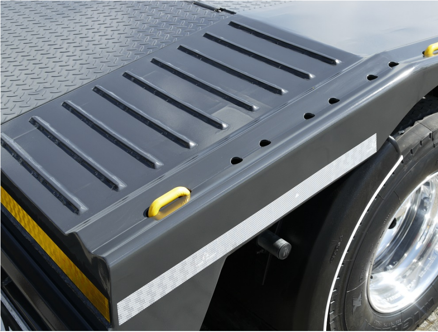
Versenkte und variabel umschraubbare Zurrpunkte im Außenrahmen
