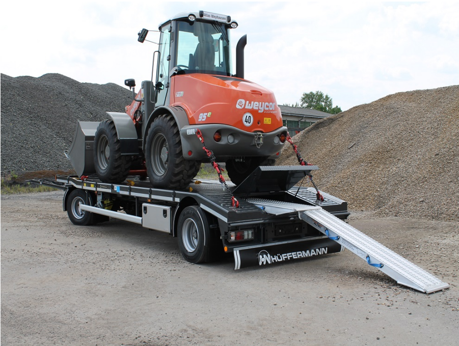
Versenkte und variabel umschraubbare Zurrpunkte im Außenrahmen
