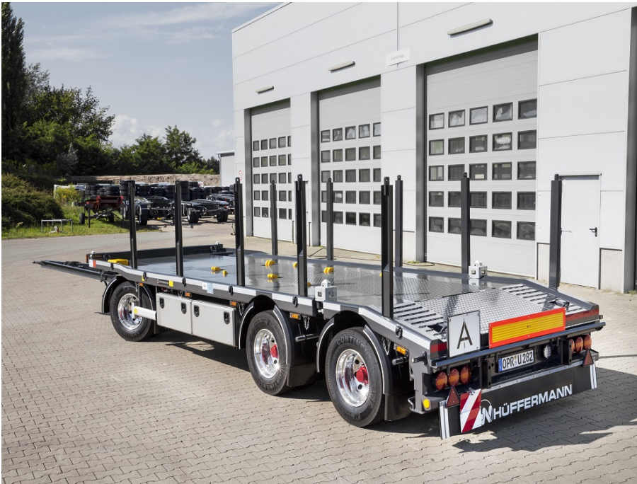
Sonderausstattung ISO-Container Aufnahme, Rungen, Aluräder und 3 LED Rundleuchten
