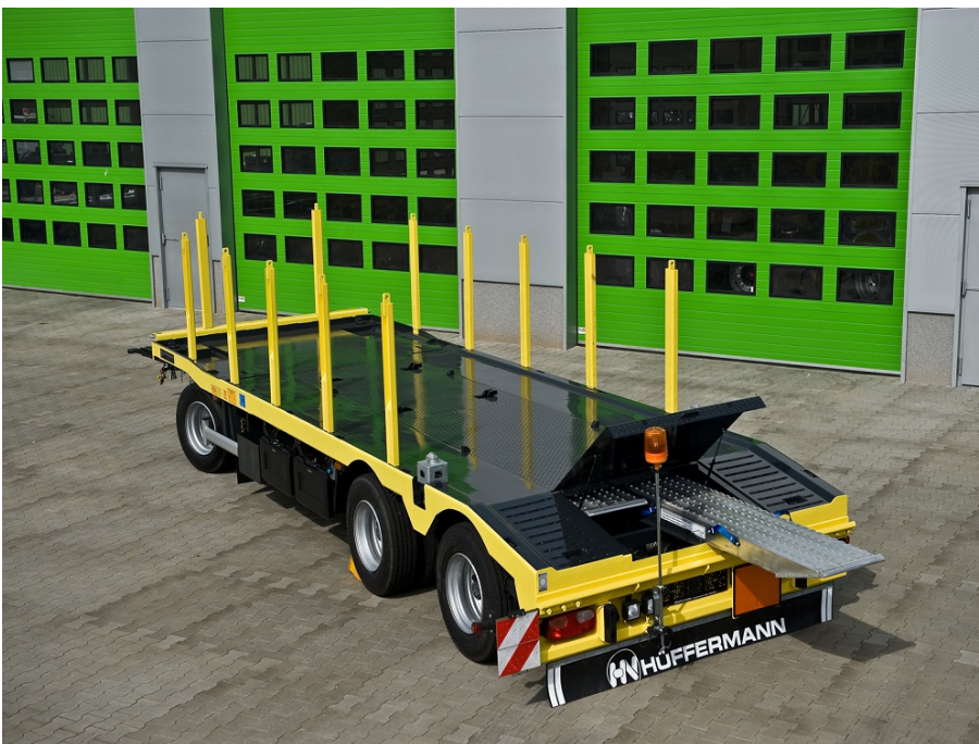
Sonderausstattung ISO-Container Aufnahme, Rungen, Aluräder und 3 LED Rundleuchten
