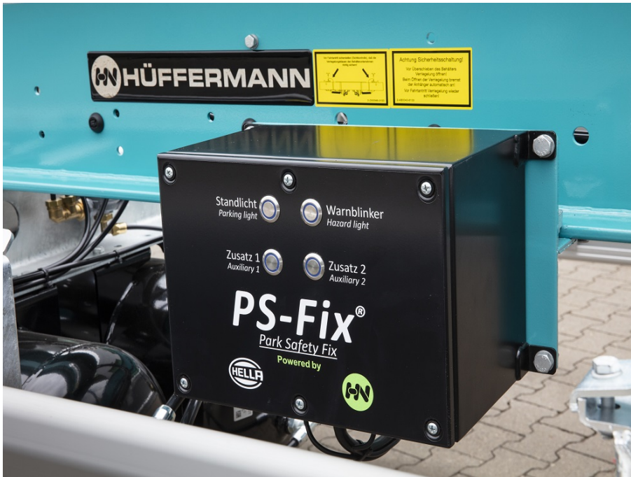
OPTIONAL: Das autarke Beleuchtungssystem für mehr Sicherheit
