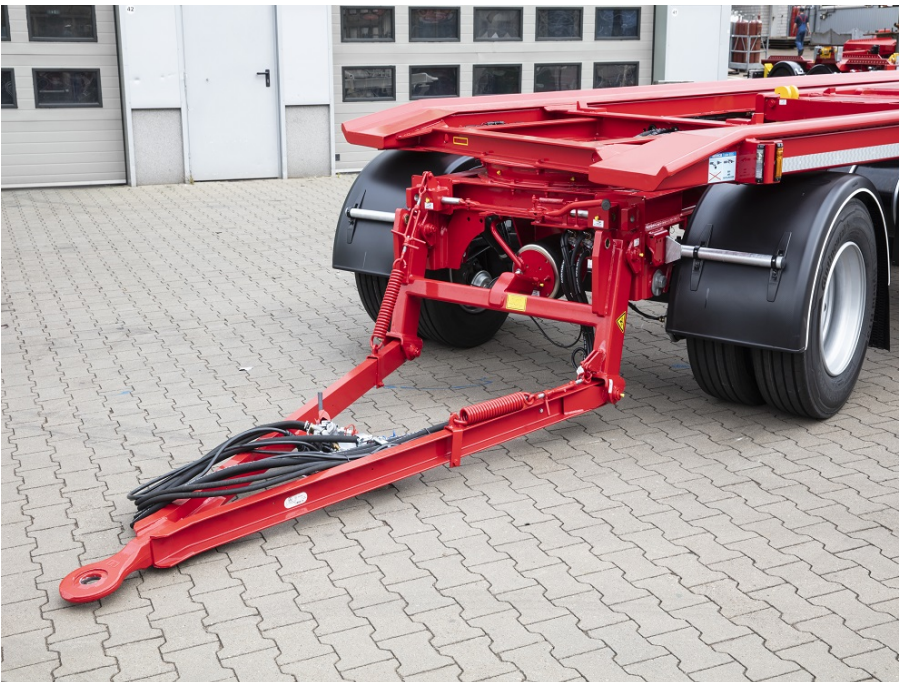
Sonderausführung Laufbahnverbreiterung Innen- und Außenzentrierung
