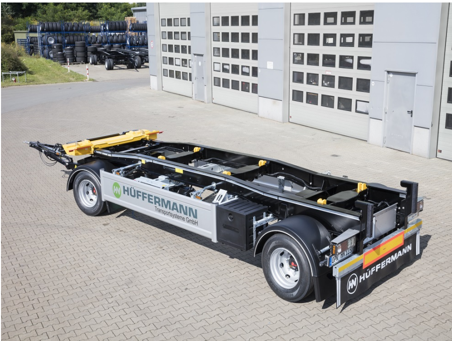
Abgesenkte Zuggabel bei Frontbeladung
