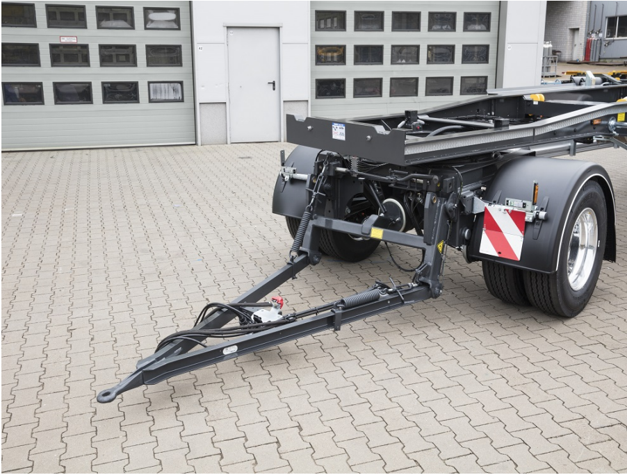
Abgesenkte Zuggabel bei Frontbeladung
